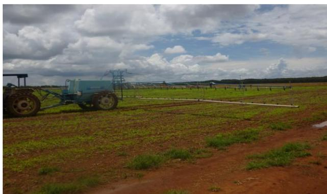
**Figura 1.** Barra auxiliar acoplada ao pulverizador.
