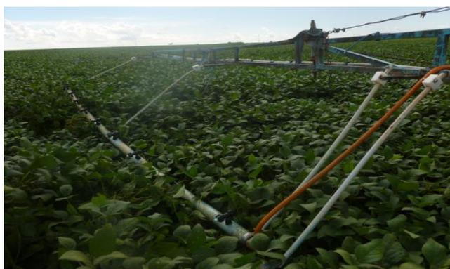
**Figura 2.** Detalhe dos bastões flexíveis que promovem a ligação entre a barra auxiliar e a barra principal do pulverizador.
