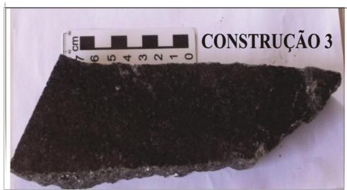
Figura 5. Amostra de gnaisse comum nas três construções do bairro Jardim do Rosário, Ituiutaba/MG.
