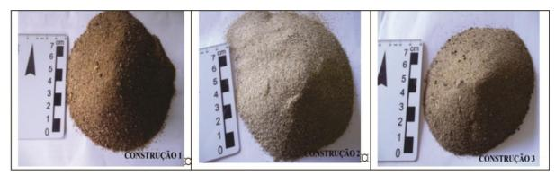
Figura 6. Areias utilizadas nas três construções do bairro Jardim do Rosário, Ituiutaba/MG.
