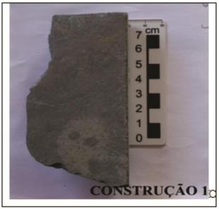
Figura 4. Amostra de ardósia comum nas três construções do bairro Jardim do Rosário, Ituiutaba/MG.
