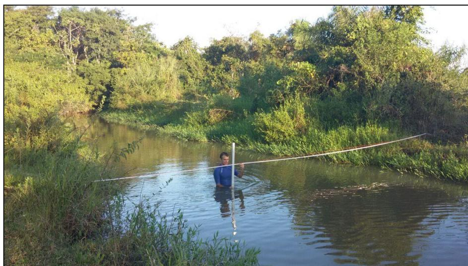
**Figura 9** - Fotografia da medição de vazão nas seções do Ribeirão Santo Antônio em 21/04/2016.
