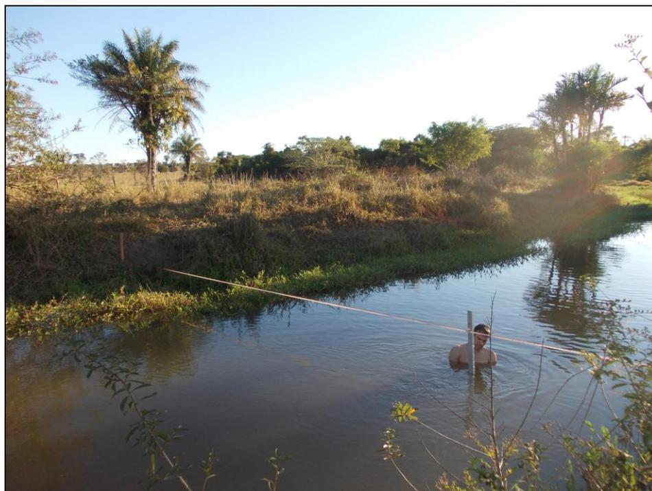
**Figura 3:** Fotografia da medição de vazão nas seções do Ribeirão Santo Antônio em 10/07/2015.
