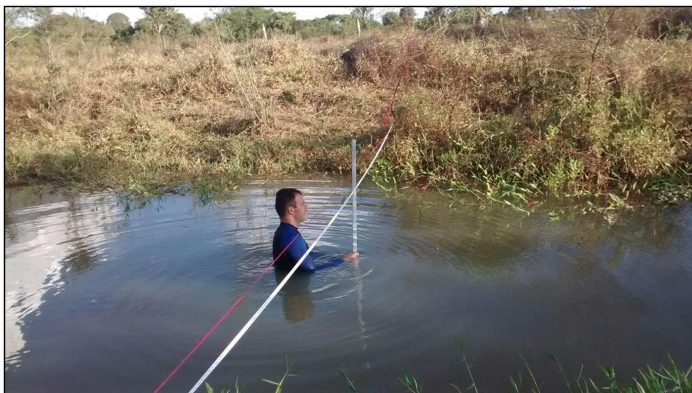
**Figura 11** - Fotografia da medição de vazão nas seções do Ribeirão Santo Antônio em 23/06/2016.
