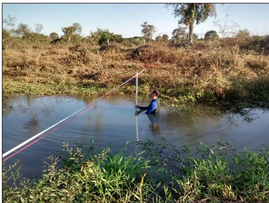
**Figura 13** - Fotografia da medição de vazão nas seções do Ribeirão Santo Antônio em 21/07/2016.
