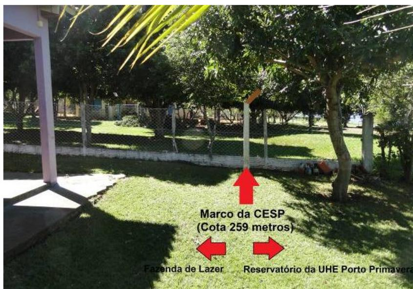
**Figura 1** - Marco da CESP, limite máximo de operação do reservatório da UHE Porto Primavera.
